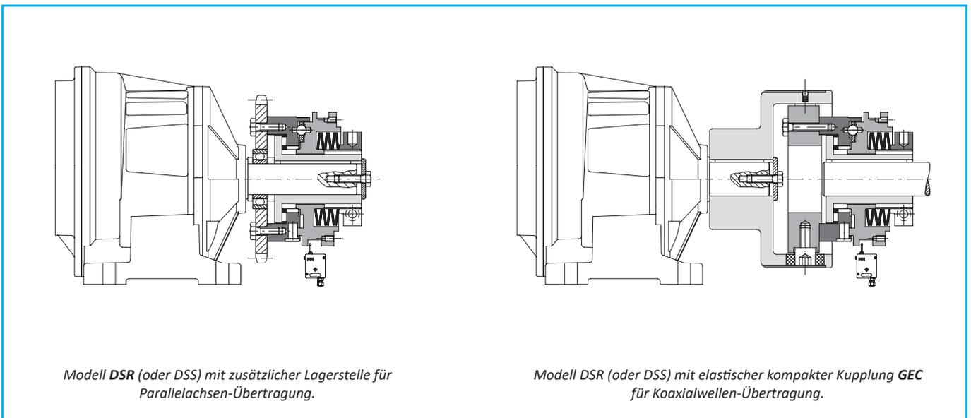
Modell **DSR** (oder **DSS**) mit zusätzlicher Lagerstelle für Parallelachsen-Übertragung.
