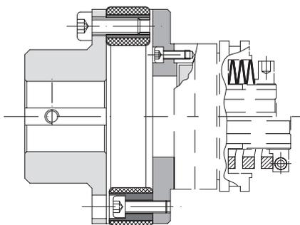
Modell DSS (oder DSR) mit flexibler Kupplung GF für die Dämpfung starker torsionaler Vibrationen und zum vereinfachten Austausch des Elastomerelements.
