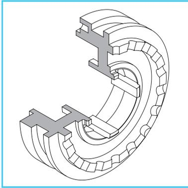
**DSR: Überlast-Rollenkupplung für eine stabile Übertragung auch bei hohen Drehmomenten und Vibrationen.**
